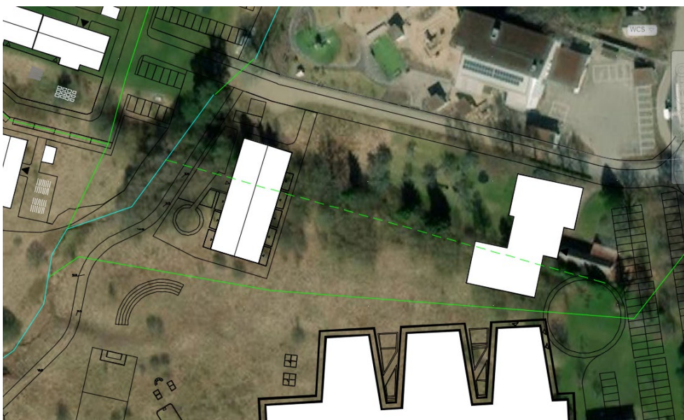
Figur 23. Befintligt läge för dike 1 markerad med streckad grön linje och ny placering redovisad med heldragen grön linje.
