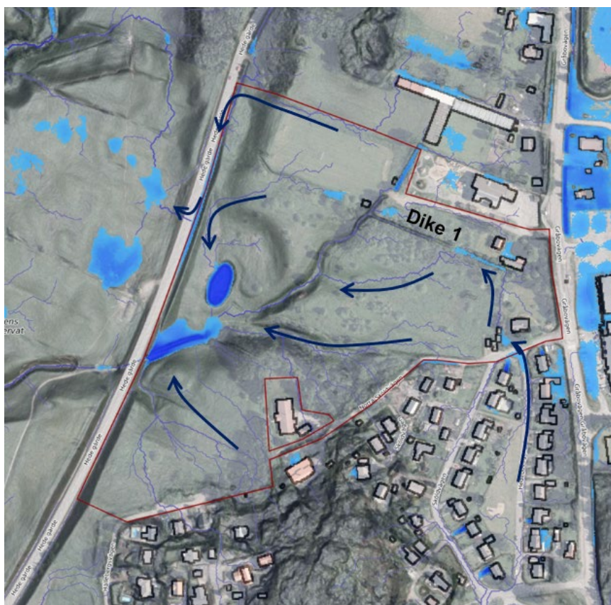
Figur 14. Avrinningsvägar och lågpunkter inom och i anslutning till planområdet enligt Scalgo Live.
