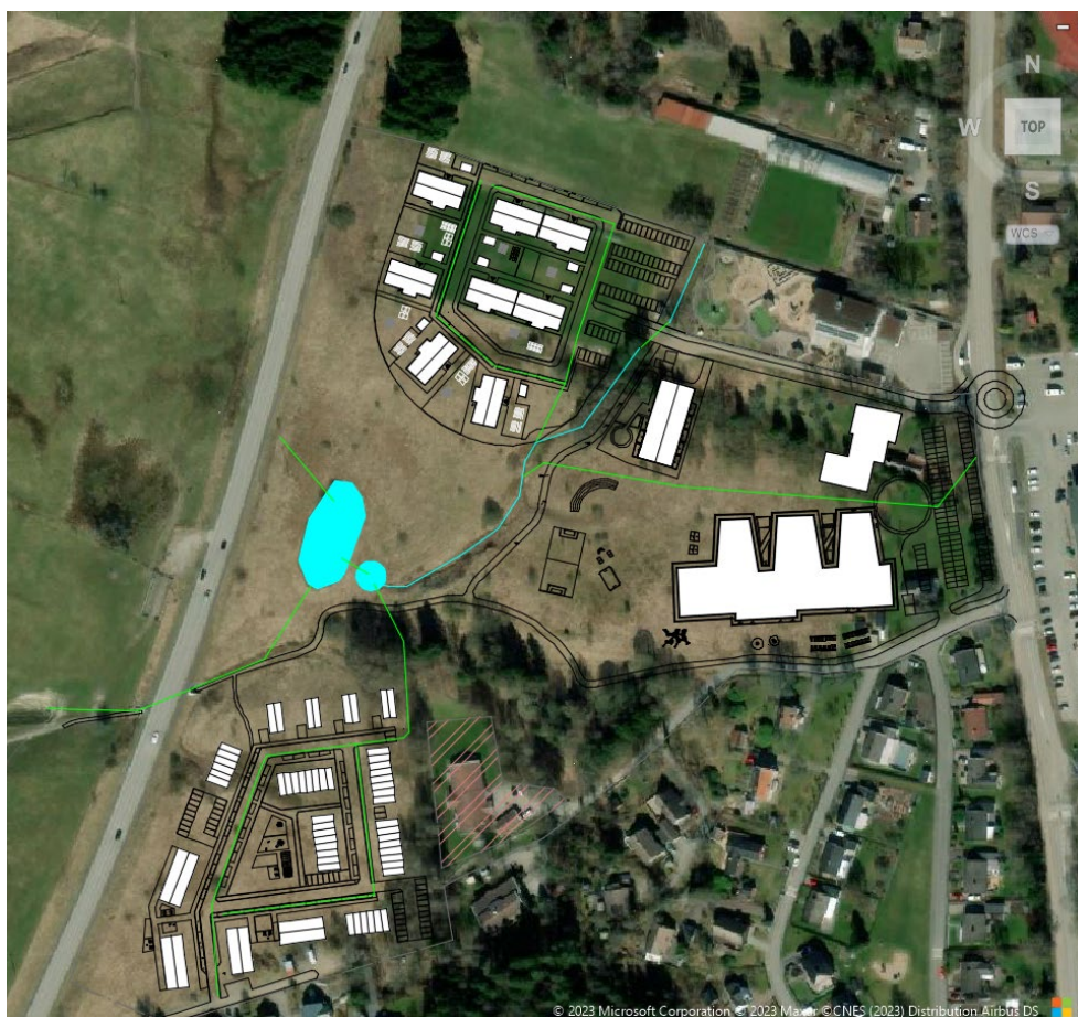
Figur 24. Principförslag på avledning av dagvatten från planerad bebyggelse. Gröna linjer motsvarar dagvattenledningar och blå linje bäcken. Blå cirkel motsvarar föreslagen fördamm och damm.
