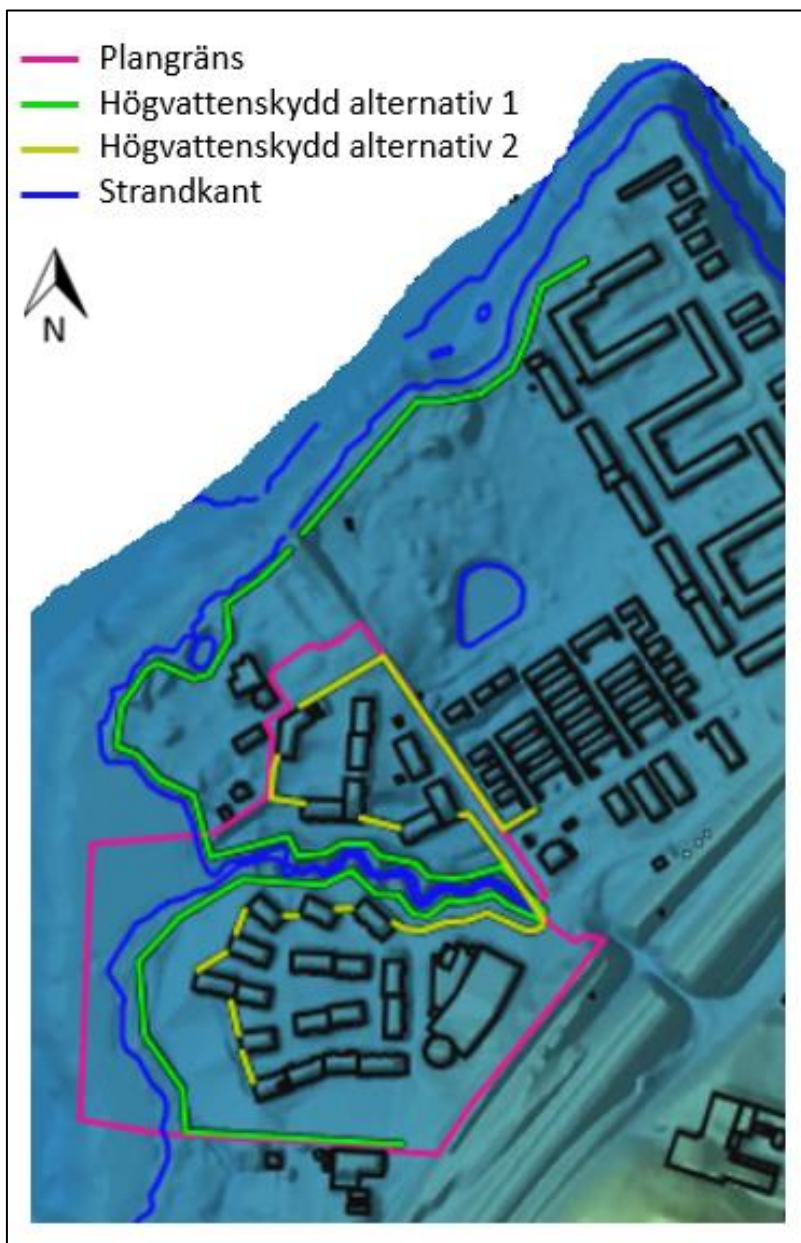
Figur 16 Två förslag på högvattenskydd i gult och grönt.
