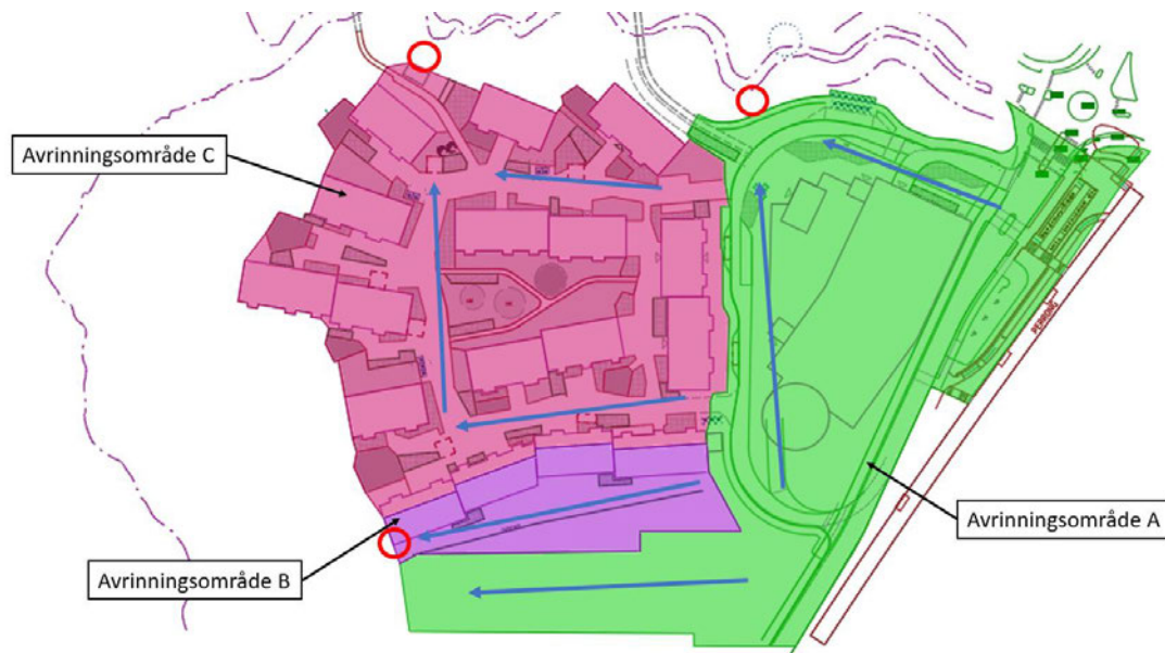
Figur 11. Avrinningsområden för den södra sidan av detaljplanen. Röda markeringar är utloppspunkter för respektive avrinningsområde.
