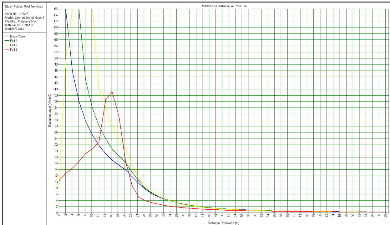
Figur 10. Strålningsnivå i kW/m 2 på olika höjd över mark som funktion av avstånd. Brandscenario; pölbrand 50 m 2 , bensin, vind 5 m/s. De olika fallen beskriver strålningen på olika höjd över marken (Base Case= 0 m, Fall 1=2 m, Fall 2=5 m och Fall 3=15 m). Not: Avstånd (x-axel) räknas från centrum av pöl
